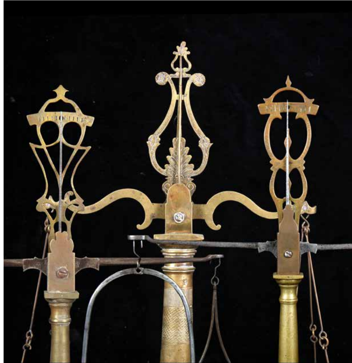
Tre soluzioni diverse per la stessa funzione: indicare quando la bilancia è in equilibrio. Bilance da orefice, Italia, seconda metà XIX secolo
