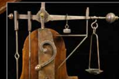
Piccola bascula della seconda metà XIX secolo; ha dimensioni ridotte per poter essere ospitata su un banco di vendita
