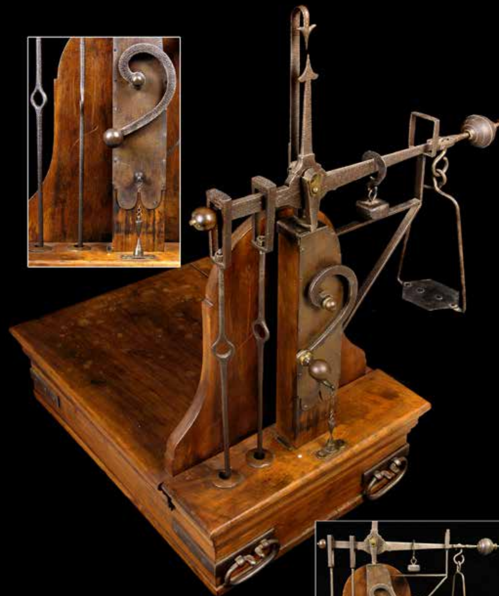
Piccola bascula della seconda metà XIX secolo; ha dimensioni ridotte per poter essere ospitata su un banco di vendita
